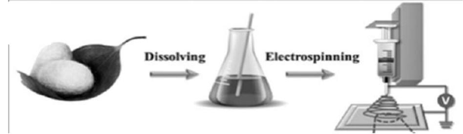
Design di sistema di elettrospinning (ugello e collettore) per la produzione di filato a base di ....sericina
